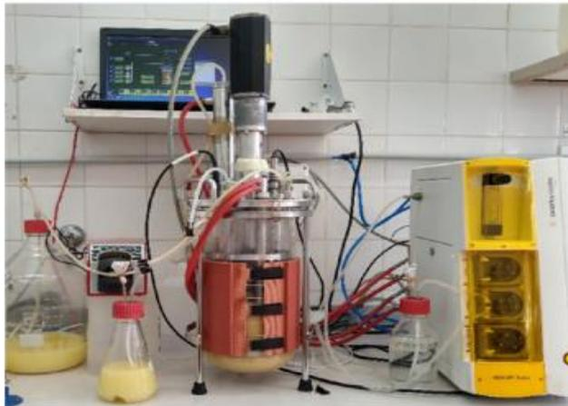
Figura 3. Cultivo Fed-Batch de *E. coli* 6576 en biorreactores de 5 L (Biostat A plus, Sartorius).
