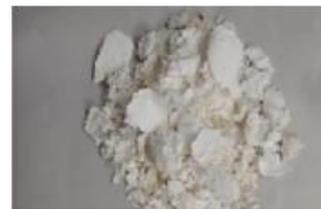
Figura 5. PHB obtenido de un cultivo de *E. coli*, utilizando la técnica de digestión con hipoclorito de sodio y lavados con acetona y etanol.
